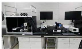
태양전지 전류 전압 특성 측정시스템
